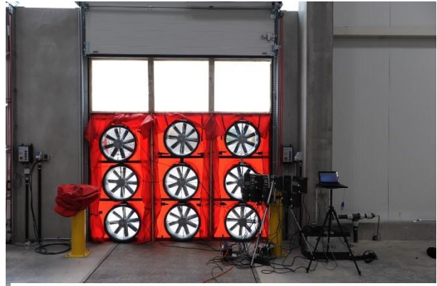
Abbildung 16: Blower-Door Test (Quelle: https://blog.pro-clima.com/de/2012/07/blower-door-skateboard/ )
